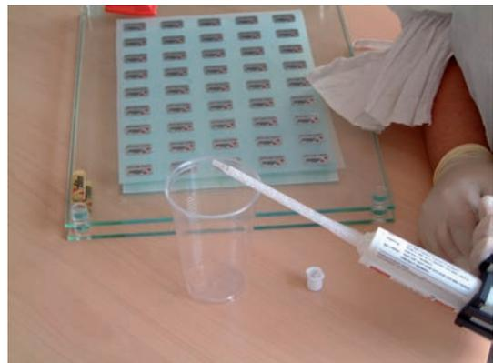
Betätigen Sie den Hebel, bis am Ende der Dosierspitze Harz austritt. Überschüssiges Harz bitte abwischen.
