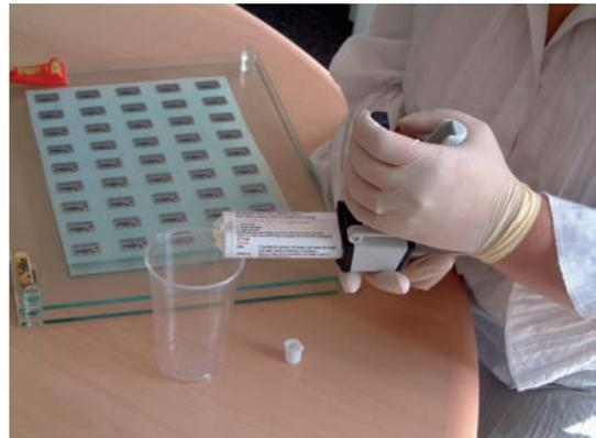
Betätigen Sie die Handapplizierpistole, bis aus beiden Zylindern Harz fließt.
