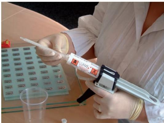
Setzen Sie jetzt die Dosierspitze mit einer leichten Drehung auf die Kartusche.
