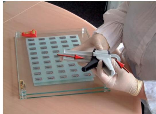
Setzen Sie den Hebel wie auf der Abbildung sichtbar in die Handapplizierpistole ein. Drücken Sie den Metallhebel an der Rückseite nach oben (kleiner roter Pfeil) und schieben den Hebel ganz hinein.
