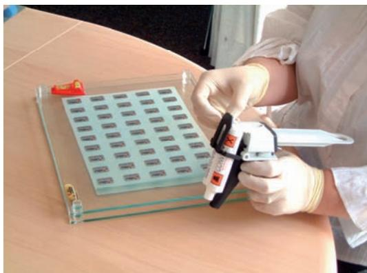
Öffnen Sie den schwarzen Bügel auf der Oberseite und installieren Sie die Doppelkartusche in die Handapplizierpistole.
